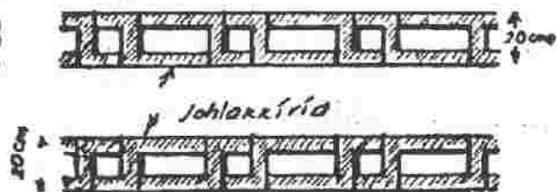
Joon. nr. 13 ja 14. Schulzi betoonkiividest seinu seotised
